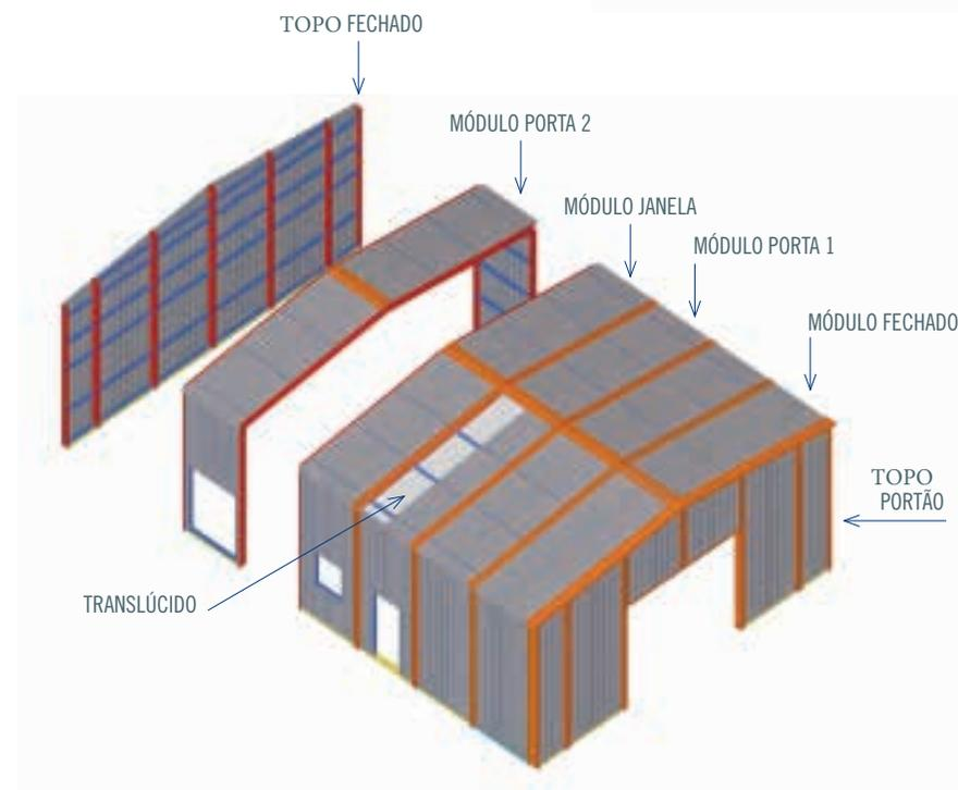
Desenvolvemos 7 modelos de dimensões standard que se podem adaptar a qualquer das suas necessidades. Esses módulos podem incorporar na sua parte lateral portas e janelas, existindo 4 tipos de módulos nos 7 modelos: módulo fechado, porta pedonal de 1 folha, porta pedonal de 2 folhas e janela.
